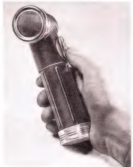
Bild 1. Das fertige Handmikrofon (Fotos: Carl Stumpf)
