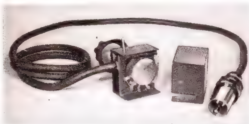
Um kleine Hf-Spannungen einstellen zu können, muß der Ausgangsspannungsregler sorgfältig abgeschirmt werden. Er ist hier mit dem zugehörigen Abschirmkästchen und dem Hf-Abschirmkabel mit Anschlußstecker sichtbar
